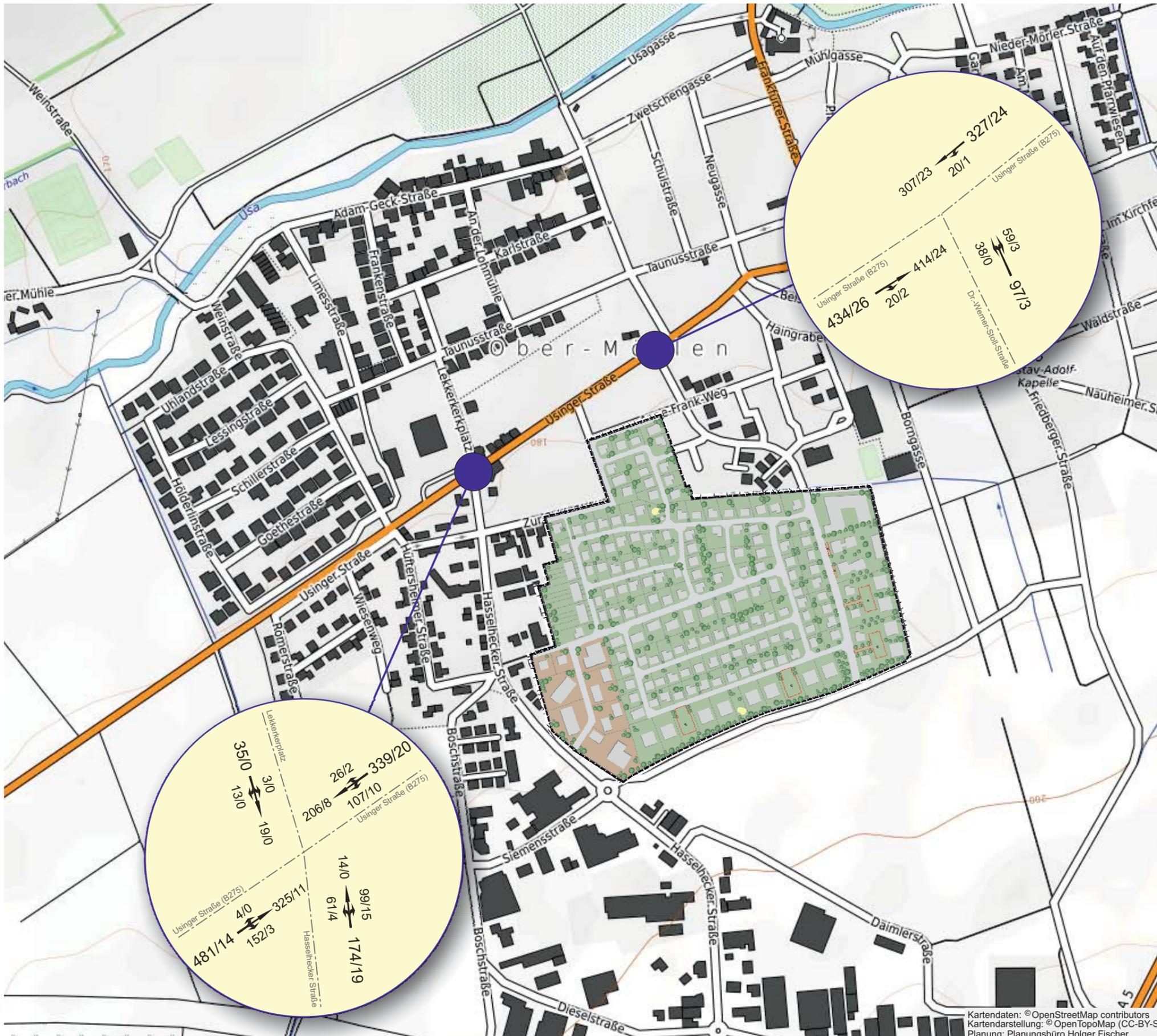
**Verkehrsbelastung Prognose mit Bauabschnitt 3**
