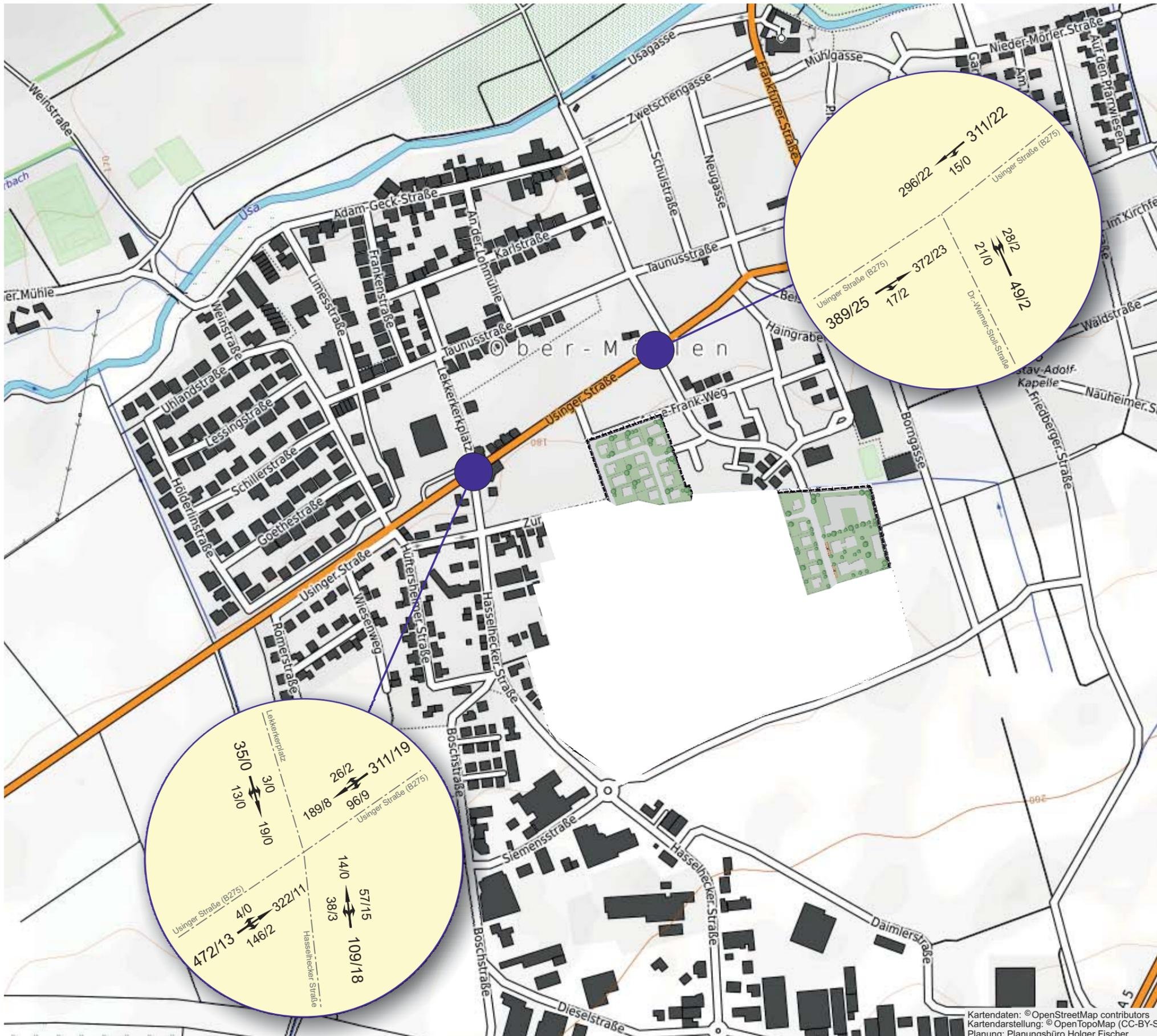
**Verkehrsbelastung Prognose mit Bauabschnitt 1**
